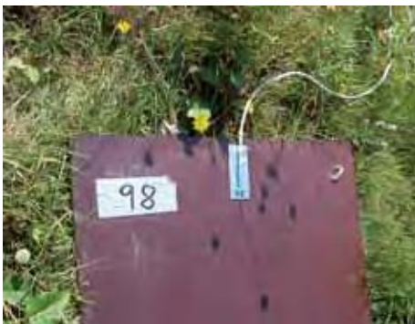
Lufthansa Boeing 747-400 fliegt über das Mikrofonfeld des DLR (oben); eines der 276 eingesetzten Mikrofone (unten).
