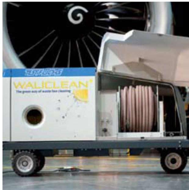
„Waliclean“: Techniker von Austrian Airlines haben dieses neue Reinigungssystem für Unterdrucktoiletten entwickelt.
