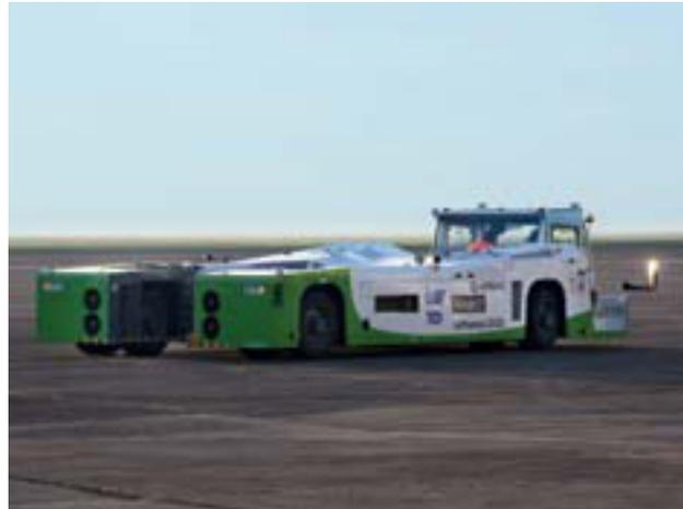
Mit TaxiBot können Verkehrsflugzeuge bei ausgeschalteten Triebwerken zur Startbahn rollen.
