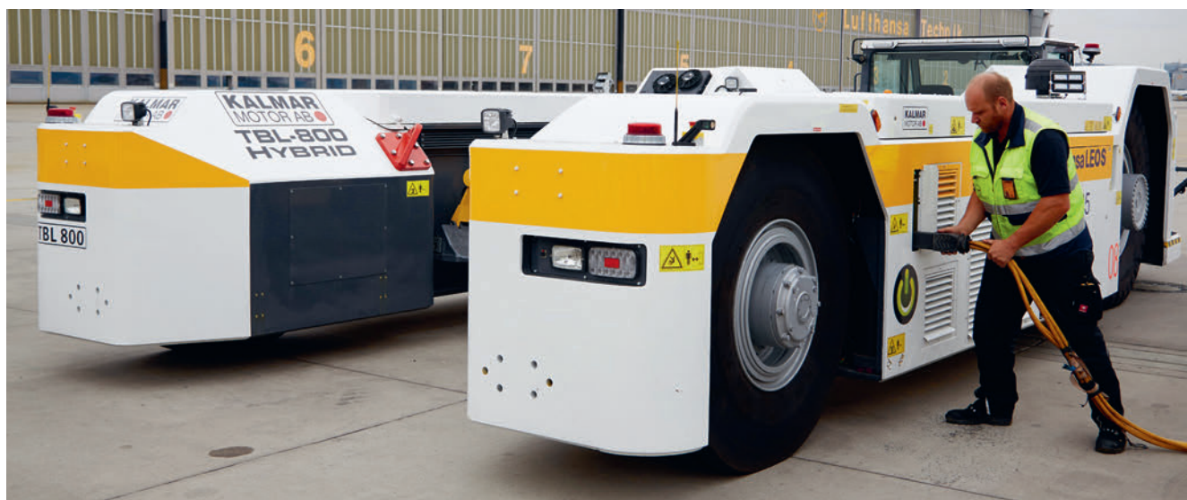
Der eSchlepper ist insbesondere für umweltschonende Wartungs- und Positionierungsschlepps großer Passagierflugzeuge gedacht.
