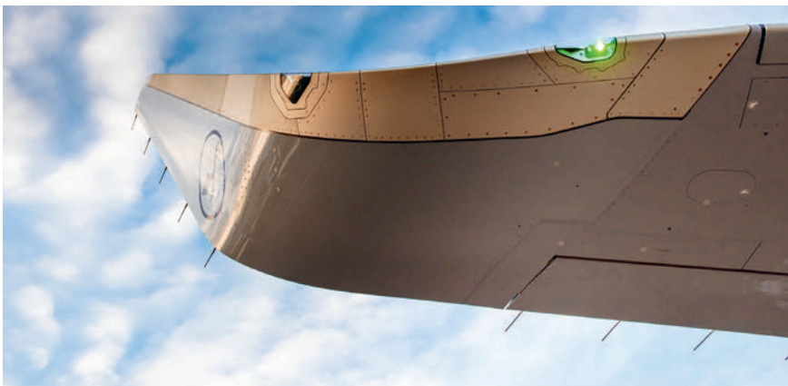
Besonders imposant sind die 2,4 Meter hohen Flügelspitzen-Verlängerungen der A320neo, sogenannte Sharklets, die aerodynamische Vorteile bringen und so die Treibstoffeffizienz verbessern.
