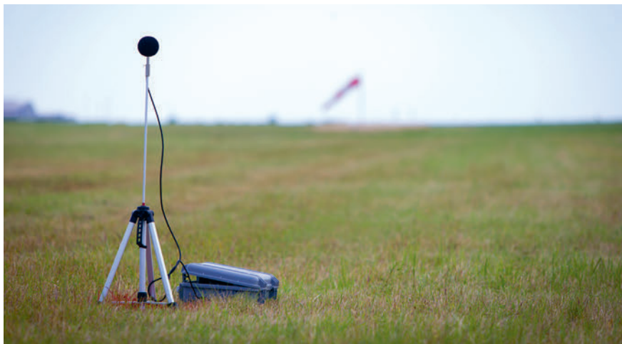
2015 fanden am Flughafen Magdeburg-Cochstedt Überflugmessungen mit MD-11-Frachtflugzeugen von Lufthansa Cargo statt, um lärmindernde Modifikationen am Trieb- und am Fahrwerk zu erproben.
