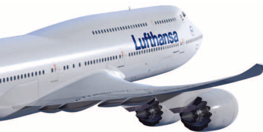
Die gezahnten Düsenaustrittskanten des GEnx-2B67-Triebwerks der Boeing 747-8 Intercontinental bewirken eine deutliche Reduzierung des Strahlärms.
