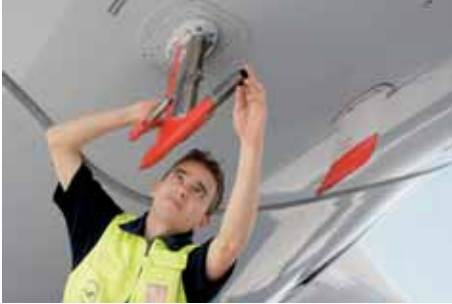
Engagement in der Klimaforschung: Das Einlasssystem unter dem Rumpf des Lufthansa-Airbus A340-600 „Leverkusen“ sammelt auf Langstreckenflügen Klimadaten in 12.000 Metern Höhe.
