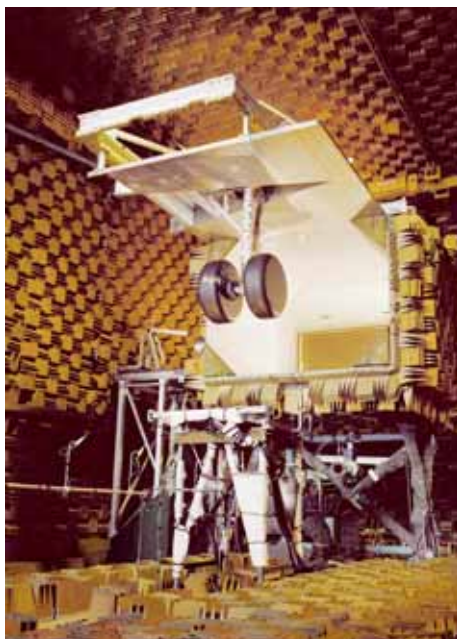
Windkanalversuch zur Auslotung des Lärmreduktionspotenzials an Fahrwerken.
