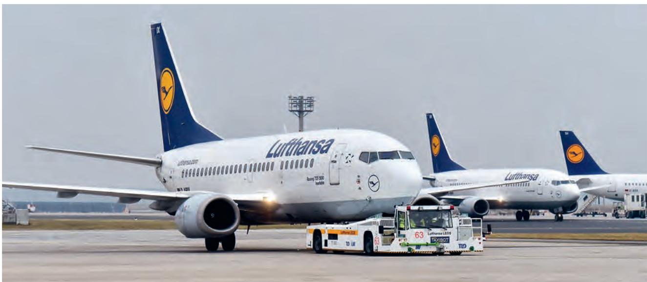
Mit dem Hybridschlepper TaxiBot können Piloten das Flugzeug im sogenannten Pilot Control Mode selbst zur Startbahn schleppen.
