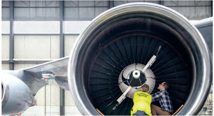
Die von Lufthansa Technik entwickelte wasserbasierte Triebwerksreinigung Cyclean® spart Airlines Zeit, Wartungskosten und vor allem Treibstoff. Das Unternehmen forscht aktuell am Einsatz weiterer Strahlmittel, wie beispielsweise CO<sub>2</sub>-Trockeneis-Pellets, um eine Reinigung auch in Permafrost-Regionen zu ermöglichen.
