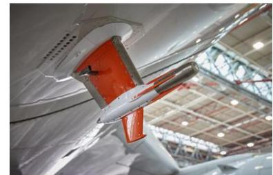
Das Labor erfasst kontinuierlich über 100 verschiedene Spurengase, Aerosol- und Wolkenparameter vom Boden bis in die Tropopausenregion in neun bis dreizehn Kilometern Höhe. Das Besondere: Klimarelevante Parameter können in dieser Höhe mit deutlich höherer Genauigkeit und zeitlicher Auflösung an Bord des Flugzeugs erfasst werden als dies mit satelliten- oder bodengestützten Messsystemen möglich wäre.
